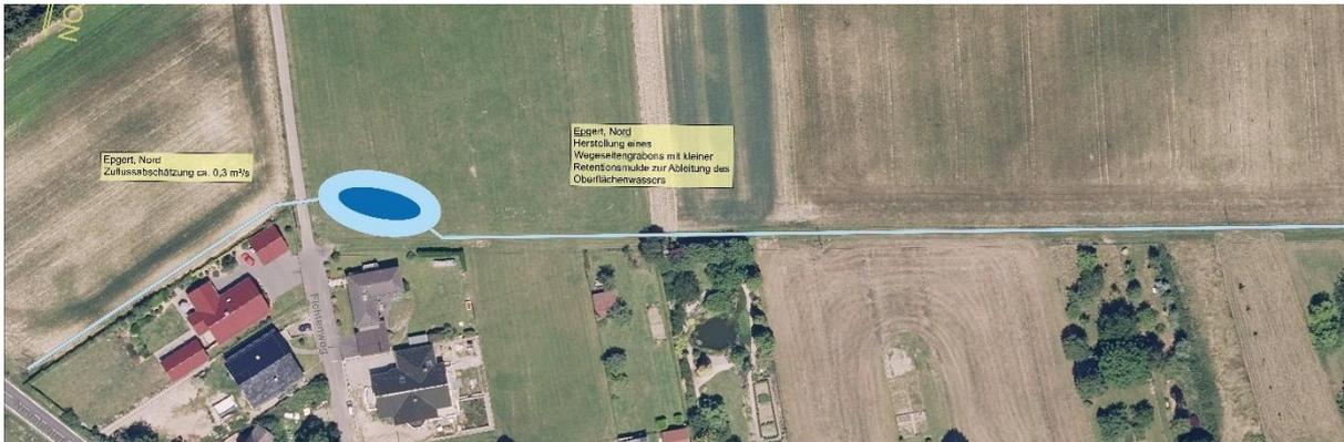
Eine kleine Rückhaltung ist durchaus geeignet, die Dimension des Grabens zu reduzieren.
